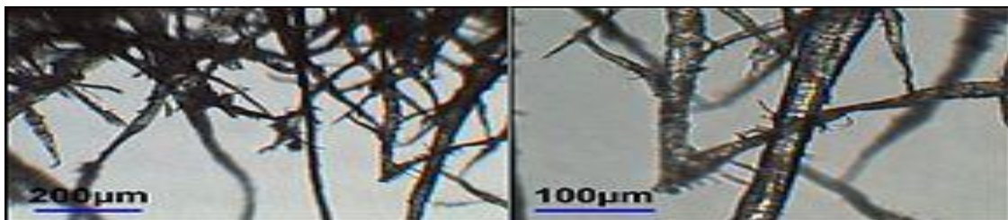
Fig. 4: La struttura delle microfibre della carta
