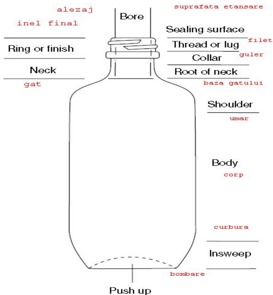
Fig 7. Componenti di una bottiglia di vetro. After RICHARD COLES, DEREK MCDOWELL, MARK J. KIRWAN FOOD PACKAGING TECHNOLOGY, Blackwell Publishing Ltd, 2003
