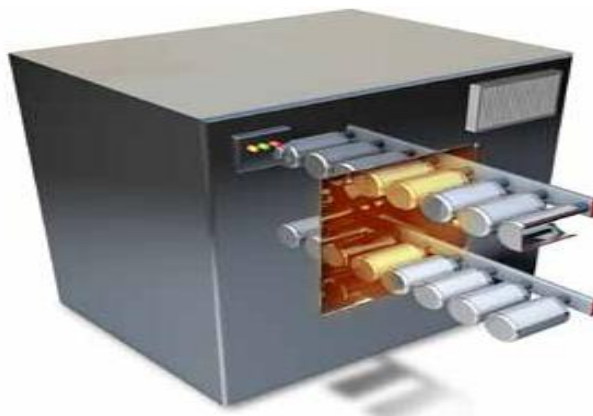
Figura 6. Secado de las latas a las que se ha aplicado el recubrimiento en el horno ( http://www.mpma.org.uk/pages/data/2piecedrinksan.pdf )
