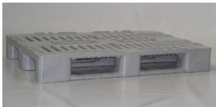
Fig. 4. Euro paleți din plastic 1200x800x160 mm. Înălțime ridicare 110 mm, masă 20 kg, capacitate 1000 kg
