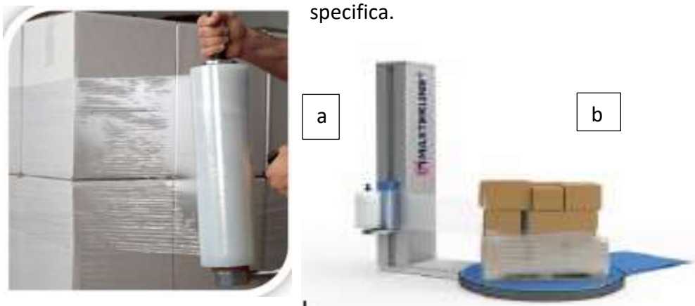
Fig 2 Nastratura dei bancali tramite film termoretraibili: sistema manuale (a) ( http://luckapack.ro ) e automatico (b) www.antal.ro stretch film
