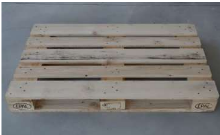
Fig. 3. Pallet in legno certificato EPAL (UIC-leaflet 435-2), trattato termicamente secondo IPPC/ISPM 15, dimensioni: 1200x800x145 mm - http://www.europalbox.ro
