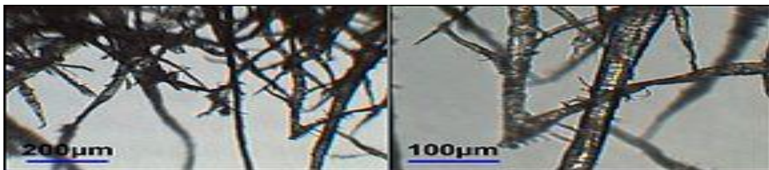
Fig. 4: La estructura de microfibras del papel
