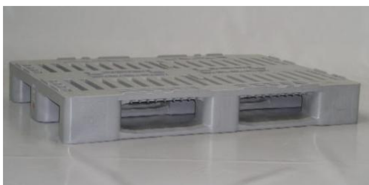
Figura 4. Europalé de plástico de 1200 x 800 x 160 mm; altura de elevación: 110 mm, peso: 20 kg, capacidad de carga: 1000 kg
